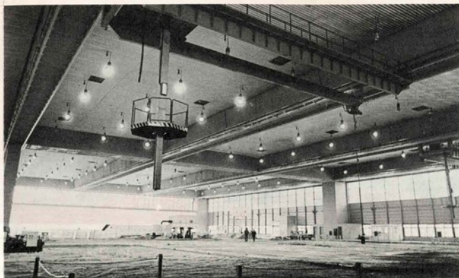
Puente-grúa que se utiliza para fotografiar los modelos
