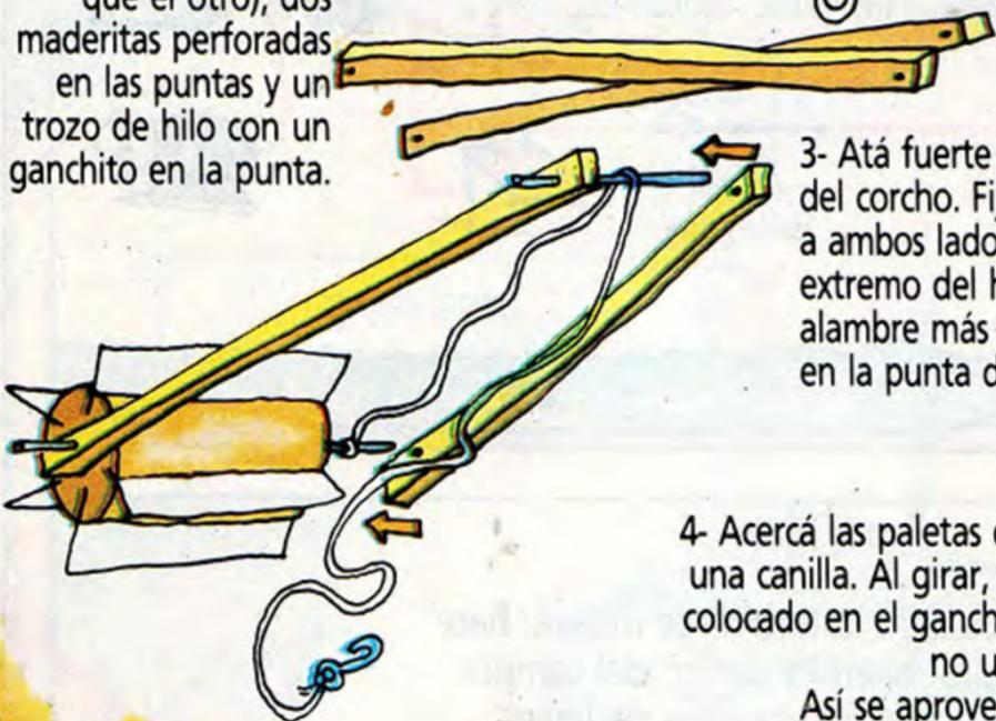
3- Atá fuerte el hilo en el eje del corcho. Fijá las maderitas a ambos lados, y pasá el extremo del hilo por el alambre más corto colocado en la punta de la madera.
