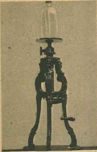
Máquina pneumática de un cilindro, expuesta en la sala de Florencia
