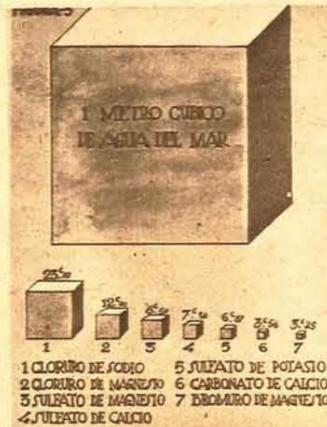
Fig. 5: Volúmenes de las principales sales contenidas en un metro cúbico de agua del mar. (La respectiva altura de los cubos se indica en centímetros)
