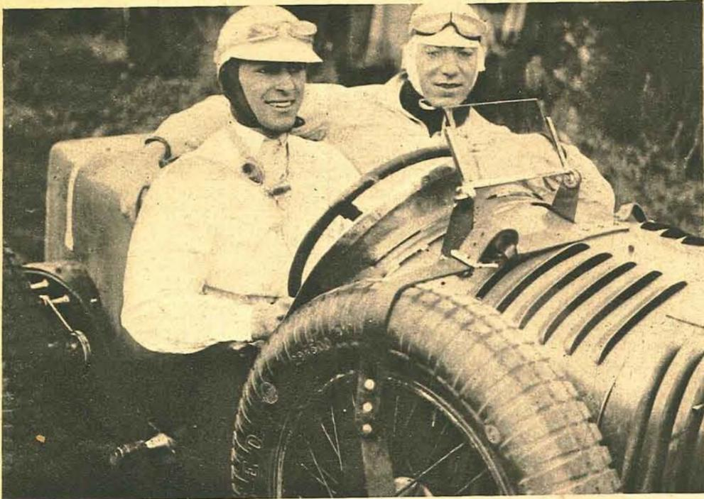
La falta de guardabarros en los coches de carrera permite que las ruedas delanteras arrojen pequeñas piedras que a la velocidad en que marcha el coche pueden causar graves daños. En la fotografía aparece el conocido volante Erick Forrest Greene y en el "capot" la pantalla de grueso cristal que lo resguarda de ese peligro.
