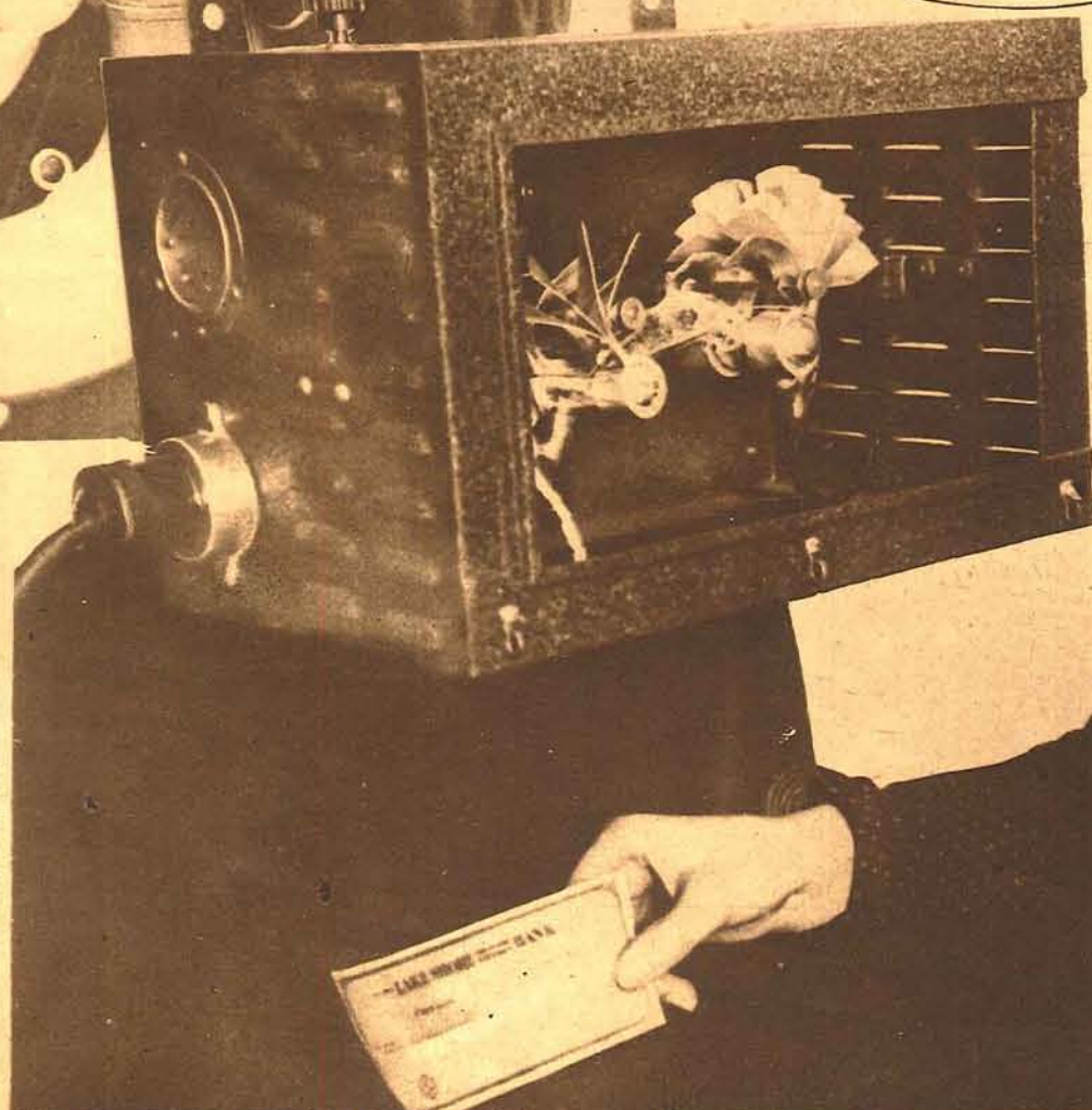
Nuevo aparato construído en los Laboratorios Block, de Chicago, que permite verificar la autenticidad de cheques, billetes de banco, sellos y piezas de moneda, por medio de los rayos ultravioleta.
