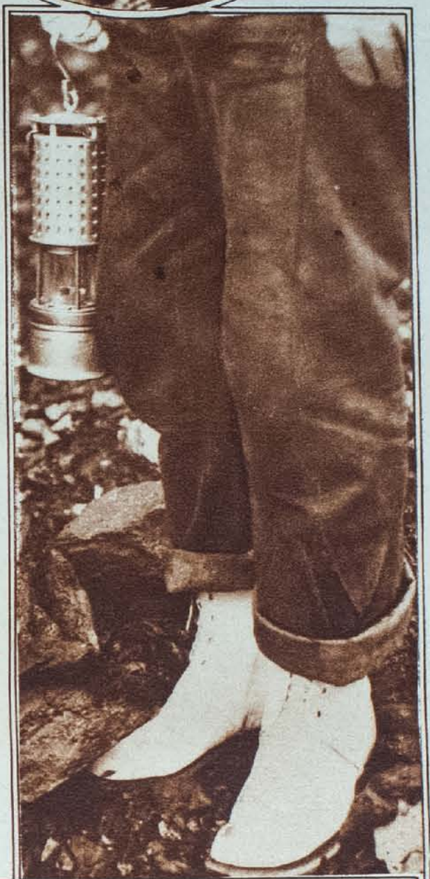
Un calzado especial y un nuevo tipo de lámpara para mineros, en uso en algunas minas norteamericanas.
