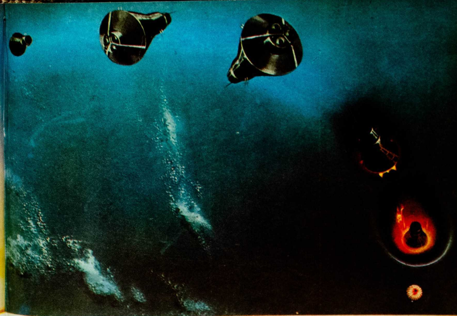
La cápsula desciende. Al atravesar la atmósfera, su blindaje térmico se consume. Un paracaídas atenúa el chapuzón final.
