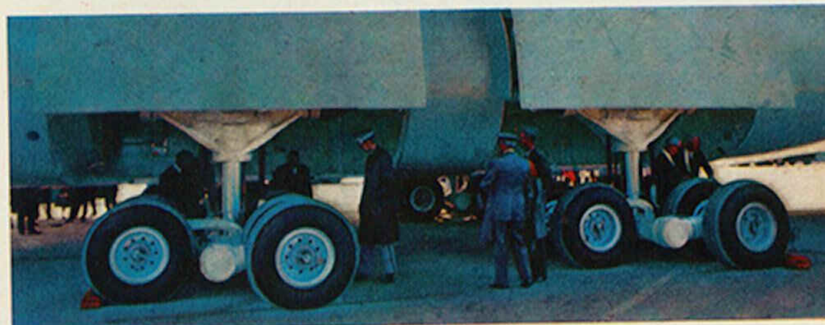
Uno de los cuatro trenes de aterrizaje: las 28 cubiertas soportan todo el peso. El inmenso Galaxy puede llevar 16 vehículos blindados, unas 120 toneladas.
